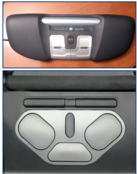
Bild 6 Beispiele für zwei Eingabemittel, die mit einem dreh- und verschiebbaren Zylinder arbeiten. Oben: Trackbar emotion™, ein autonom arbeitendes USB-Gerät. Unten: Ausschnitt von der RollerMouse™.
