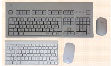
Bild 2 Beispielhafter Größenvergleich von zwei Tastaturen. Oben: Beispiel für eine Standardtastatur. Unten: Beispiel für eine Kompakttastatur. Die untere Maus befindet sich etwa im Greifraum einer mittelgroßen Person, während die obere Maus außerhalb des Greifraums aller Menschen steht.
